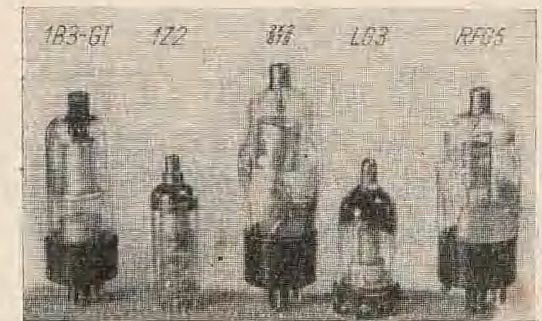
Rys. 9-5. Lampy prostownicze wysokiego napięcia
