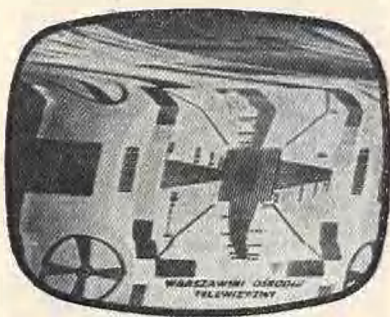
Brak synchronizacji poziomej
